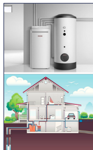
Figuur 3-3: Schematische werking van een bodemlus
