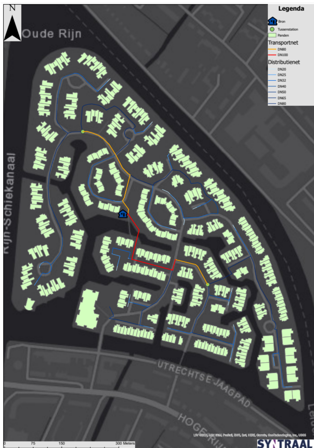
Figuur 6-2 Ontwerp van het MT-net op basis van rekenprogramma Comsof Heat®.
