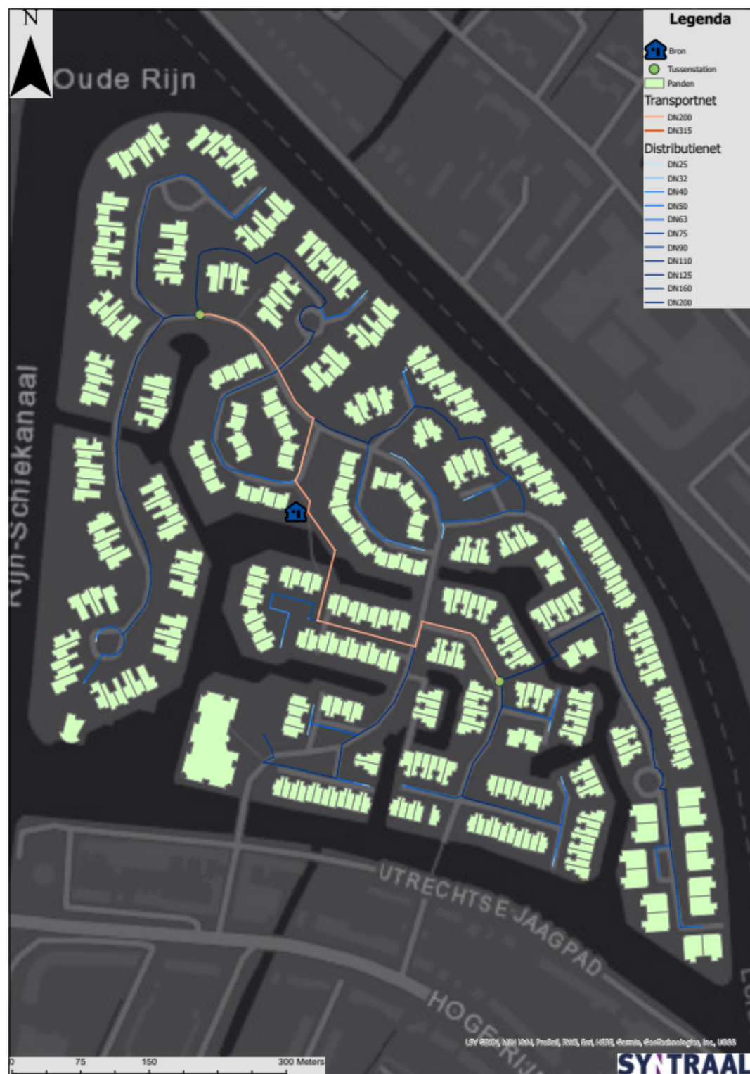
Figuur 6-1 Ontwerp van het bronnet op basis van rekenprogramma Comsof Heat®.
